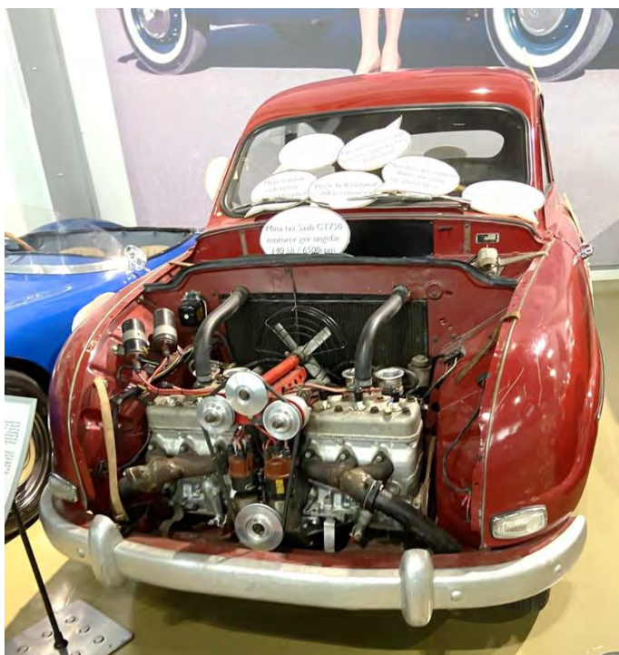
Over: «Monsteret». Eksperiment fra 1959 med to sammenkoblede motorer. Toppfart 196km.
